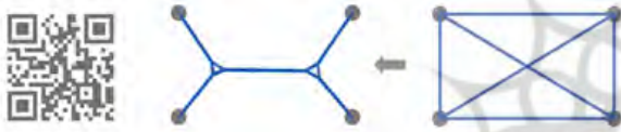
تصویر ۷. از چپ: تمام مسیرهای مستقیم ممکن، مسیر بهینه به کمک فرمیابی فیزیکی رشته‌های خیس در گرسه‌پار و بارکد شبیه‌سازی آن. مأخذ: نگارندگان.
