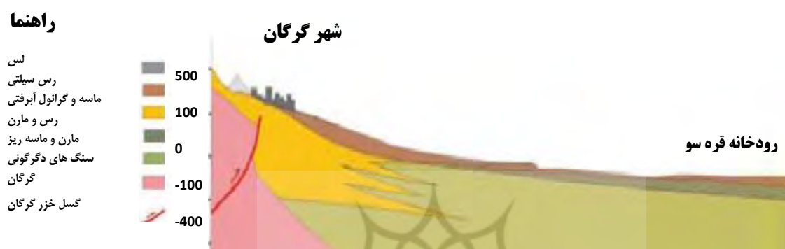
شکل (۲): پروفیل لایه‌بندی خاک در گرگان - برش زمین‌شناسی از نهشته‌های آبرفتی دشت گرگان. این برش با راستایی شمالی-جنوبی از شهر گرگان تا رودخانه قره‌سو بر پایه اطلاعات ۵ حلقه چاه آب اکتشافی و بهره‌برداری رسم شده است اقتباس از نقشه سازمان زمین‌شناسی و اکتشافات معدنی کشور
