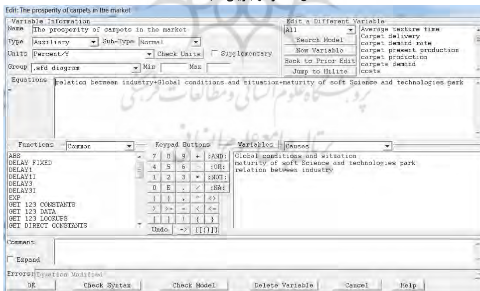
شکل ۵: نمونه رابطه ریاضی تعریف شده در نرم افزار ونسیم PLE
