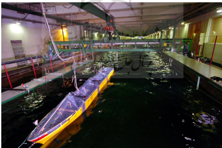
انجام آزمایش در حوضچه کشش
