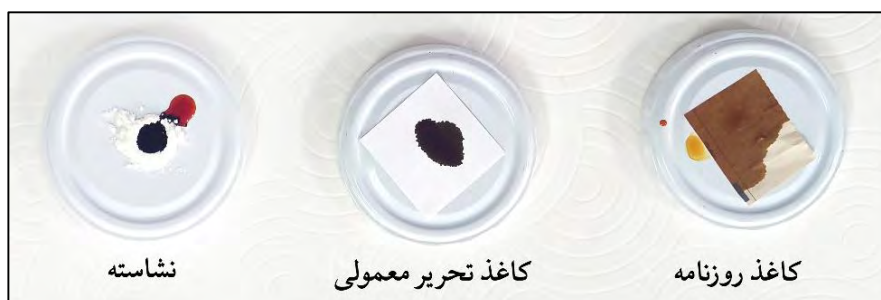
شکل ۵. آزمایش آشکارسازی وجود نشاسته قابل توجه در سطح کاغذ تحریر معمولی و فقدان آن در کاغذ روزنامه
