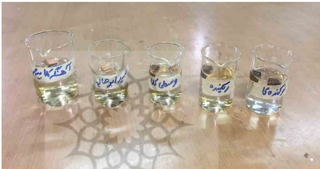
تصویر ۴: غوطه‌وری نمونه‌های چوبی استخراج‌شده از سقانفارها در آب مقطر و طلائی شدن آب در برخی از آن‌ها (نگارنگان، ۱۴۰۰). Fig. 4: Immersion of wooden samples taken from Saqanefars in distilled water and turning the water to golden color in some of them (Authors, 2020).
