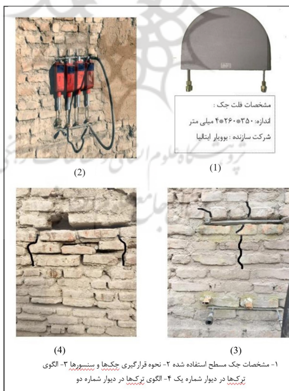
شکل ۹. روند انجام تست فلت جک (Aminifar et al., 2022)
