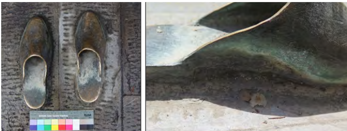
شکل ۲. محصولات خوردگی در محل اتصال اثر به زمین در ارتباط با رطوبت
