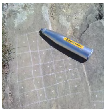
شکل ۶: چگونگی برداشت نمونه چکش اشمیت بر روی لایه‌های ماسه‌سنگی.
