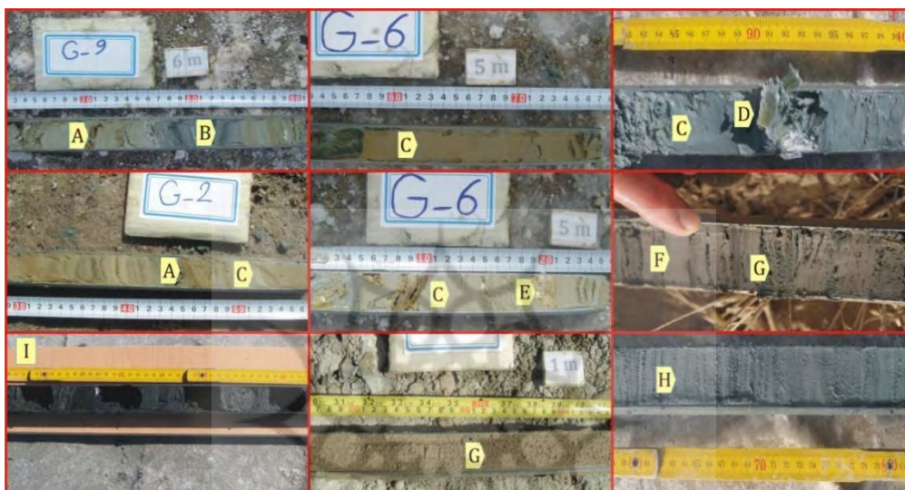
شکل ۴: رخساره‌های موجود در مغزه‌های پلایای گاوخونی: A: رس قهوه‌ای رنگ لامینه‌ای، B: مواد آلی خاکستری تا سیاه‌رنگ مربوط به محیط دلتایی یا دریاچه‌ای، C: رخساره گل نرم به رنگ‌های کرم و گاه قهوه‌ای مربوط به محیط پلایایی، D: ژپیس درشت بلور ثانویه تحت تأثیر محلول‌های غنی از سولفات، E: لامینه‌های نمک در عمق‌های مختلف، F: رس به رنگ‌های مختلف در عمق‌های مختلف در تناوب یا رسوبات دانه‌درشت مربوط به محیط رودخانه‌ای، G: رخساره ماسه قهوه‌ای رنگ خشک (ماسه‌های بادی)، H: تناوب لامینه‌های ماسه‌ای و سیلنتی یا گلی مربوط به محیط‌های دریاچه‌ای، I: برداشت نمونه از مغزه‌ی تهیه‌شده
