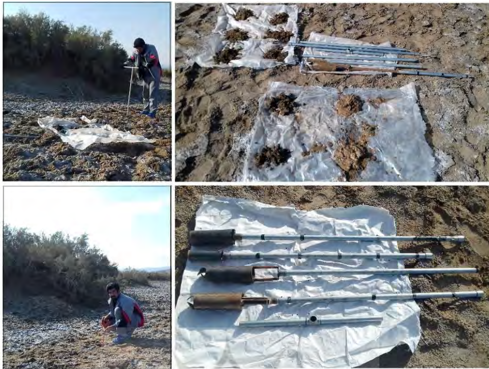
شکل ۳: تصاویری از روش و ابزار نمونه‌برداری میدانی در عرصه‌ی طبیعی
