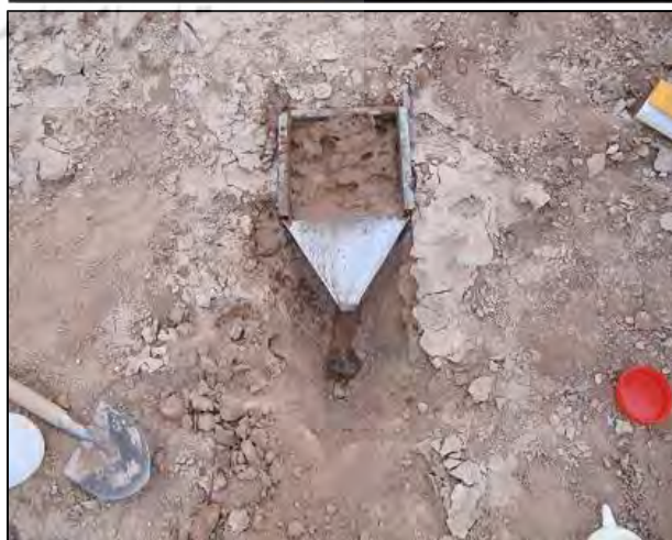
شکل ۳: (بالا و پایین) نمایی از شبیه‌ساز باران مورد استفاده و ابعاد آن (۲۵*۲۵ سانتی‌متر)، (راست) اندازه‌گیری عمق نفوذ آب بارش در خاک
