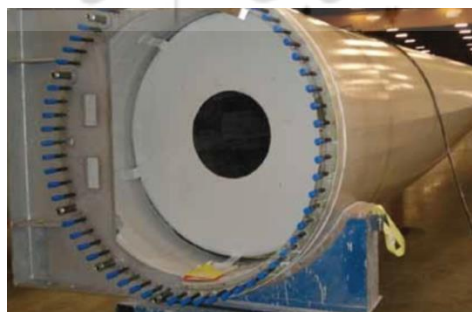
شکل ۱۵. هندسه ریشه پره توربین بادی و موقعیت نصب فن مکنده
