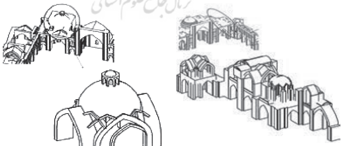
تصاویر ۱ و ۲. سازه گنبدخانه فضای مدرس در مسجد حکیم؛ ماخذ: آرشیو نگارندگان.
