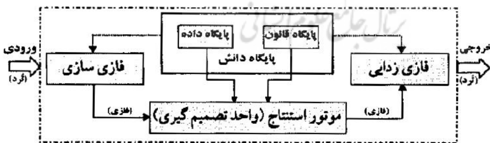
نمودار ۲. شمای کلی و مراحل اصلی یک سیستم فازی؛ منبع: فسخودی، ۱۳۸۴، ص ۵۱.
