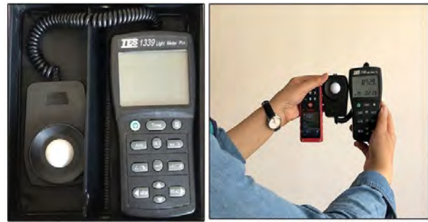
تصویر ۱۲ - اندازه‌گیری روشنایی (به واحد لوکس) در فضای مسکونی.
