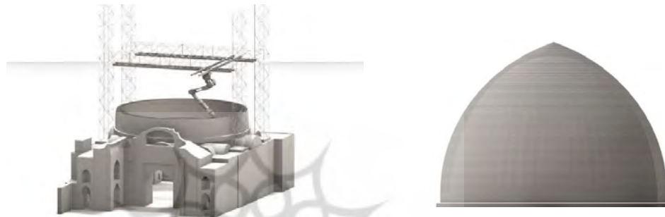
تصویر ۱۲: راست: گنبد نورگذر دوبوسته ی به هم پیوسته؛ پوسته ی داخلی کاملاً فشاری و پوسته ی بیرونی از جغد چمانه. چپ: پرینت سه بعدی گنبد بر روی بنا توسط بازوی رباتیک (ترسیم: نگارنده)
