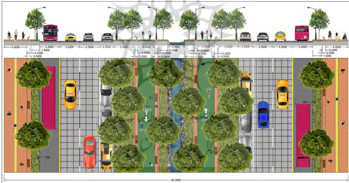
شکل ۶. نمای کلی از برش عرضی طرح پیشنهادی بلوار کشاورز
