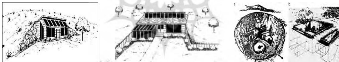
شکل ۴- طبقه‌بندی کلی خانه‌های زمین‌پناه - (پ) حالت تپه- خاکریز (ب) مستقر در دامنه کوه (الف) حالت آتریوم‌دار
