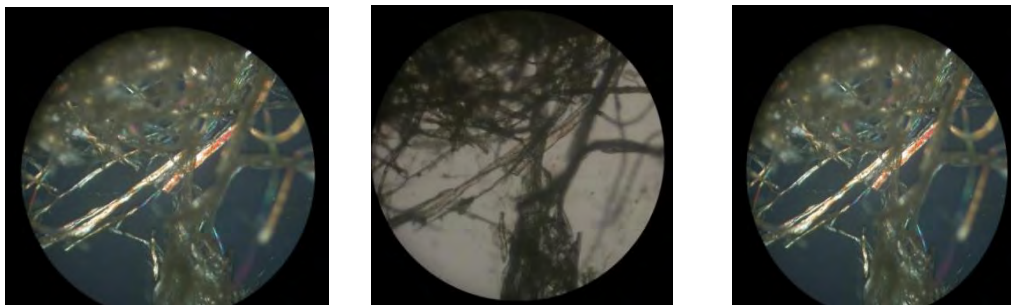
تصویر ۸: (راست) تصویر میکروسکوپی الیاف کاغذ حاشیه نسخه پنج گنج در زیر نور معمولی، (چپ) همان نمونه زیر نور پلاریزان، بزرگنمایی X200
