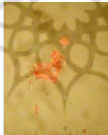
تصویر ۲۲: تصویر میکروسکوپی رنگ قهوه‌ای (نمونه ۲۴) که نشان دهنده وجود شنگرف و رنگدانه دیگری است که این رنگدانه در زیر میکروسکوپ شناسایی نشد، بزرگنمایی X400
