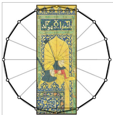
تصویر ۷. اندازه سردر ورودی بر اساس تناسبات شانزده‌ضلعی منتظم. (نگارندگان)
