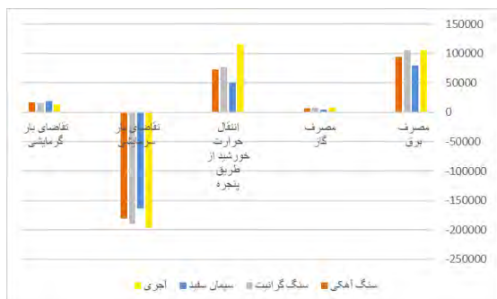
نمودار ۶: مقایسه عملکرد حرارتی مدل پایه با مصالح مختلف در روزهای منتخب (منبع: نرم افزار دیزاین بیلدر)
