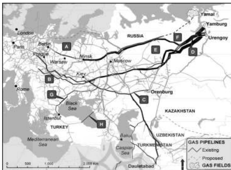
شکل شماره (۴): مسیرهای خطوط لوله پیشنهادی و موجود صدور گاز ترکمنستان؛ منبع: Victor and others, 2006
