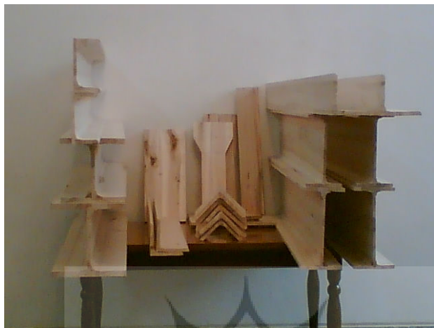
شکل ۶ : پروفیل‌های I، U و L شکل در کنار و ادوات اتصال در میان
