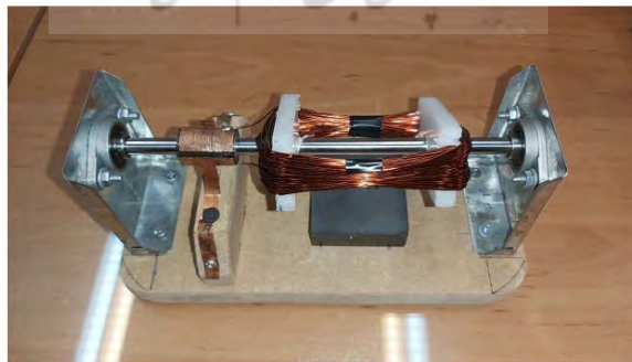
شکل ۱. نقشه موتور، (الف): نقشه انفجاری، (ب): نقشه مونتاژ، (ج): نمونه نهایی ساخته شده
