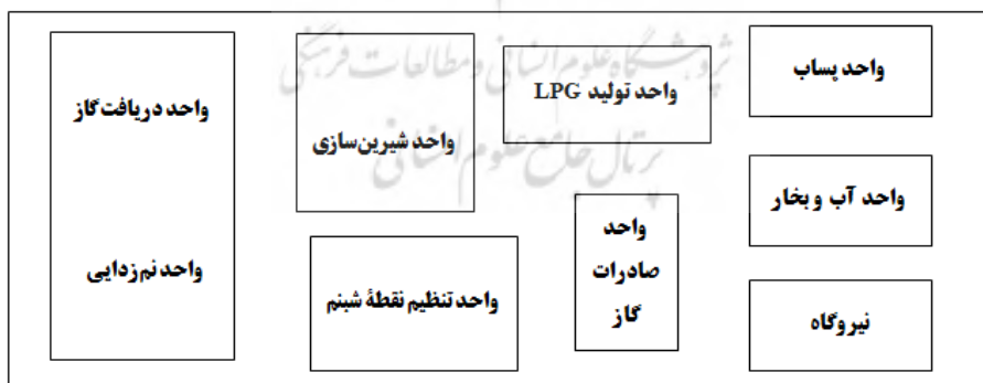
شکل ۳: ساختار کلی یک پالایشگاه گاز
