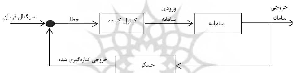
شکل ۱: شماتیک حلقه کنترلی
