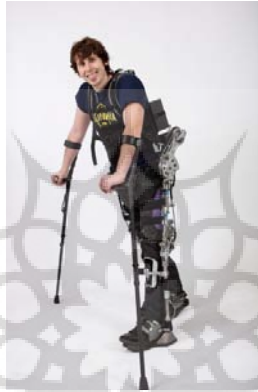
شکل ۶: سیستم اسکلتی پروژه آستین
