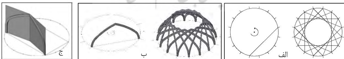
تصویر ۱: کاربردی شاقولی: الف- هندسه پلانی، ب- هندسه سه‌بعدی. مأخذ: نگارندگان، ج- باریکه طاق در کاربردی سرسفت. مأخذ: امجد محمدی و همکاران، ۱۳۹۹.
