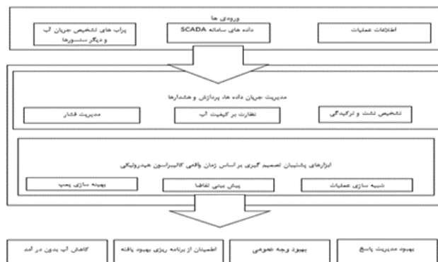
شکل ۱: بررسی اجمالی عملکرد پلت فرم WaterWiSe با کاربردهای فعال شده توسط سیستم یکپارچه داده ۱ و هشدارهای الکترونیکی و ماژول پشتیبانی از تصمیم ۲ و یک مجموعه منتخب از مزایای دیده شده (مایکل النا و همکاران، ۲۰۱۲).
