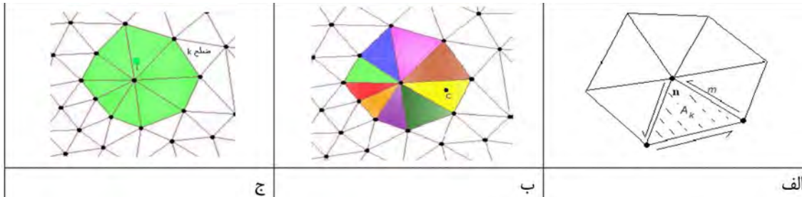
شکل ۳. حجم کنترل های مورد استفاده در شبکه مثلثی بیساختار الف- المان مثلثی با مساحت مقادیر مشتقات (جابجایی) کرنش) در مراکز المان ب- حجم کنترل فرعی محاسبه A_k ج- حجم کنترل اصلی برای محاسبه مقادیر جابجایی در نقاط گرهی (رتوس المان).
