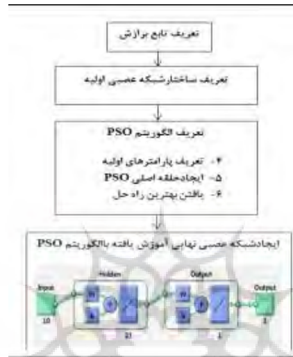
شکل ۱. فرایند بهینه‌سازی شبکه عصبی توسط الگوریتم حرکت تجمعی ذرات با ساختار MLP
