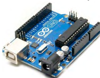
شکل ۳. برد آردوینو Uno مبتنی بر میکروکنترلر ATmega328
