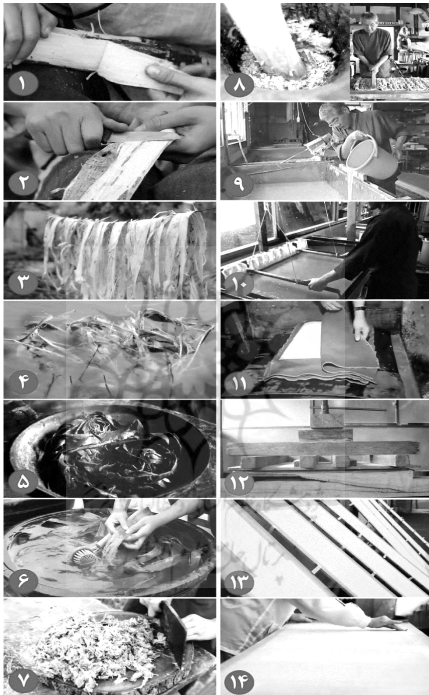
شکل ۲. مراحل ساخت کاغذ از پوست درخت توت
