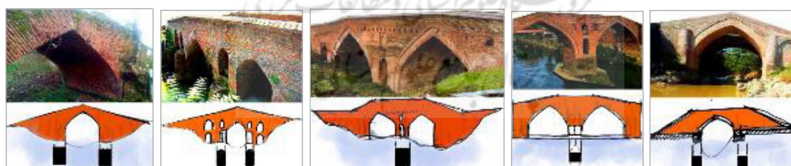
تصویر ۲۳. فرم پایه: مستطیل و فرم موج‌شکن: دایره‌ای؛ پل پونل (صفویه) (نگارندگان، ۱۴۰۰) تصویر ۲۴. فرم پایه: مستطیل و فرم موج‌شکن: لوزی؛ پل لنگرود (صفویه) (همان) تصویر ۲۵. فرم پایه: مستطیل و فاقد موج‌شکن؛ پل خشته پورد لاهیجان (صفویه) (همان) تصویر ۲۶. فرم پایه: مستطیل و فرم موج‌شکن: دایره؛ پل لیشاوندان (قاجاریه) (همان) تصویر ۲۷. فرم پایه: مستطیل و فاقد موج‌شکن؛ پل فومن (صفویه) (همان)
