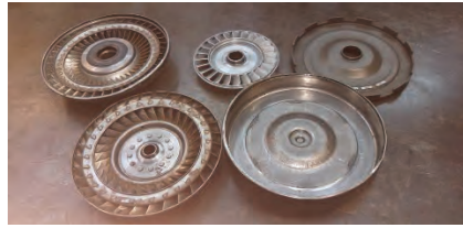
مبدل گشتاور (تورک‌کانورتور) برش خورده
