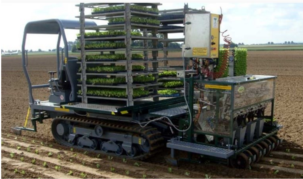
شکل ۷: کاربرد مهندسی مکترونیک در کاشت خودکار نشاء [۱۷]
