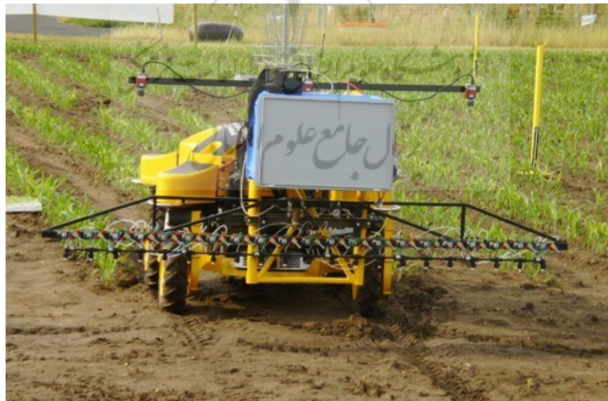
شکل ۸: کاربرد مهندسی مکترونیک در کنترل خودکار علف‌هرز برای کشاورزی در مقیاس بزرگ [۱۴]
