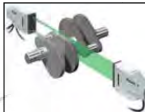
شکل ۲: اندازه گیری ابعاد خارجی شفت میل لنگ
