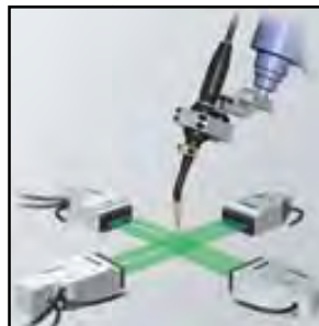
شکل ۱: اندازه گیری موقعیت سیم جوشکاری
