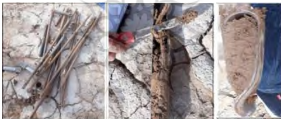
شکل ۳: تصاویر مغزه گیر دستی و محل مغزه برداری پیلایای دامغان
