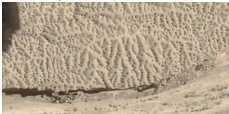
شکل ۹: تصویری از سطح یک بلوک با چاله‌های قیفی فراوان (نقطه‌های تیره) در سطح آن
