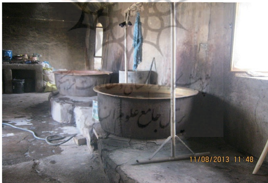
عکس ۱۲- سلابه: یا پایه که در بالای دیگ قرار می‌گیرد که نخ‌های رنگ شده را روی آن قرار می‌دهند. (نویسنده. مرداد ماه ۱۳۹۲)
