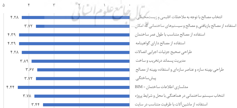
شکل ۵. میانگین وزن شاخص‌های مصالح و روش ساخت با توجه به اهمیت شاخص در طراحی ساختمان کم‌کربن در ایران
