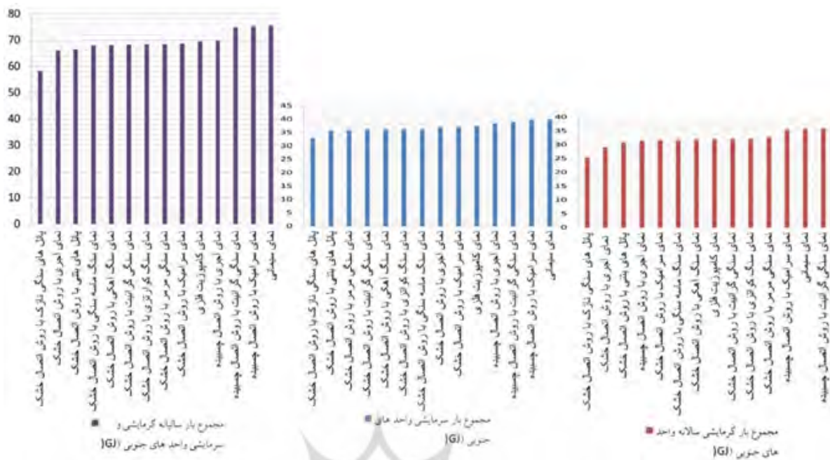
شکل ۴. مقایسه انرژی مصرفی در ساختمان‌های رو به جنوب با انواع مختلف نماسازی. Figure 4. The comparison of energy consumption in south-facing buildings with different facades.
