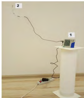
تصویر ۲- موقعیت قرارگیری دستگاه دیتالاگر داخلی، ۱- دستگاه اصلی بر روی یک پایه به ارتفاع تقریبی 90cm گذاشته شده و دمای هوا و رطوبت نسبی محیط داخل را ثبت می‌کند؛ ۲- سیم ترموکوپل دستگاه بر روی دیوار چسبانده شده است و دمای سطح داخلی دیوار را ثبت می‌کند.
