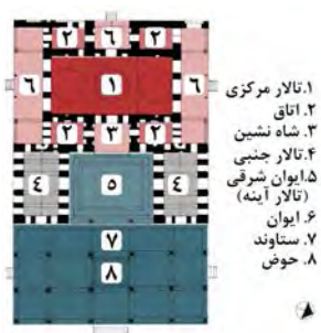
تصویر ۱- فضاهای کاخ چهلستون از راست؛ جزئیات ستاوند، پلان ستاوند سه طرف باز، تصویر ستاوند و انعکاس آن در آب، معرفی فضاهای کاخ.
