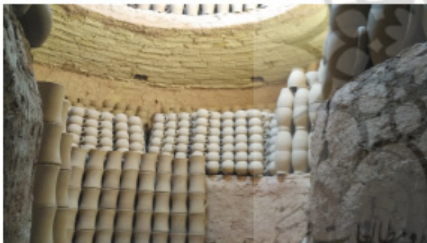
تصویر ۲. خروجی‌های به کاررفته در زیر طاقچه در کوره سفال لالچین. مأخذ: آرشیو نگارندگان.
