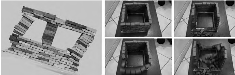
تصویر ۲۷: بررسی رفتار دیوارهای بنایی استفاده از روش دوران صفحه زمین. راست: بررسی شکست عمود بر صفحه. چپ: بررسی اثر بازشوها. مدل سازی، فیلم و عکس از دانشجویان: نازنین نایبالی، فاطمه مکی و نگین شرفی، درس روستا، ۱۳۹۹.
