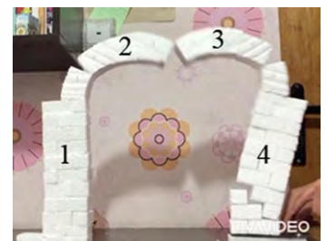
تصویر ۹: سازه به چهار قسمت تفکیک می‌شود. قطعات ۱ و ۴ نقش پایدارکننده و قطعات ۲ و ۳ نقش ناپایدارکننده دارند. مدل سازی، فیلم و عکس از دانشجو: فاطمه عرب‌پور، درس سیستم‌های ساختمانی، ۱۳۹۸
