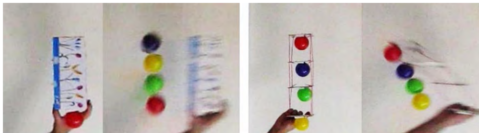
تصویر ۲۰: در حرکت جسم صلب (چپ)، شتاب وارد بر تمامی نقاط سیستم یکسان است؛ اما در جرم منعطف، شتاب نقاط مختلف متفاوت‌اند (راست). (تصویرها به صورت معکوس قرار داده شده‌اند).
