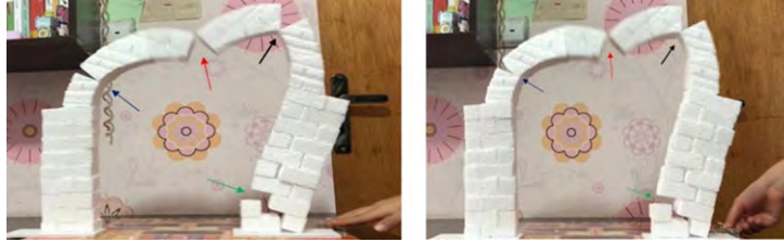
تصویر ۱۶: مکانیسمی با چهار ترک (تقریباً مشابه نشست) ناشی از اثر زلزله. راست: ترک‌های ناشی از ضربه. چپ: ترک در آغاز ربع سیکل اول ۳۳ در حرکت رفت‌وبرگشتی. مدل‌سازی، فیلم و عکس از دانشجو: فاطمه عرب‌پور، درس سیستم‌های ساختمانی، ۱۳۹۸
