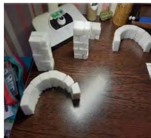
تصویر ۴: راست: هندسه قوس. چپ: آماده‌سازی قطعات قوس بدون چسباندن. اثر دانشجو: کیمیا افلاطونیان، درس
