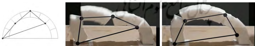
تصویر ۲۴: مسائل پیچیده‌تری چون محل متفاوت مفاصل‌ها در مدل تجربی نسبت به مدل نظری (تصویر ۲۳) در رفتار قوس ظهور می‌نماید؛ درحالی‌که محل مفاصل در مدل تصویر وسط بر مدل نظری منطبق است، در مدل تصویر راست، محل مفاصل‌ها تغییر کرده است.
