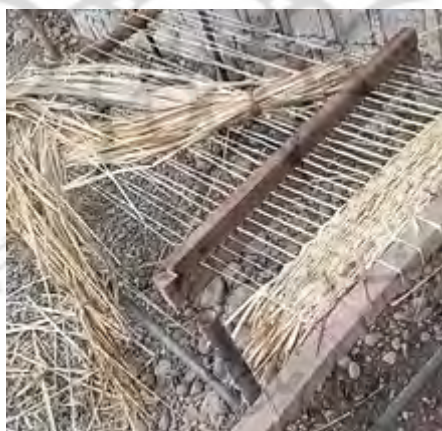
تصویر ۶- بافت زیرانداز در گیلان به روش «تاروپودی» با دستگاه کوب بافی (نگارندگان، ۱۴۰۰).
