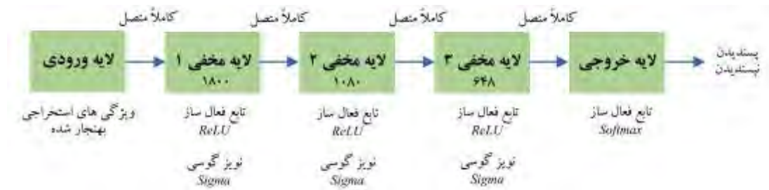
شکل ۴: ساختار شبکه DNN با سه لایه پنهان
