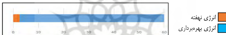
شکل ۱۰. متوسط انرژی نهفته و دوره بهره‌برداری جداره‌های متداول مسکن سندج در زمان ۶۰ سال
